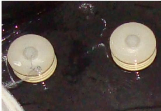
現場混床樹脂塔使用疊片式集散水器。
